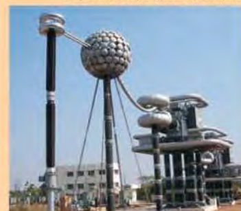
1200kV CVT under test
