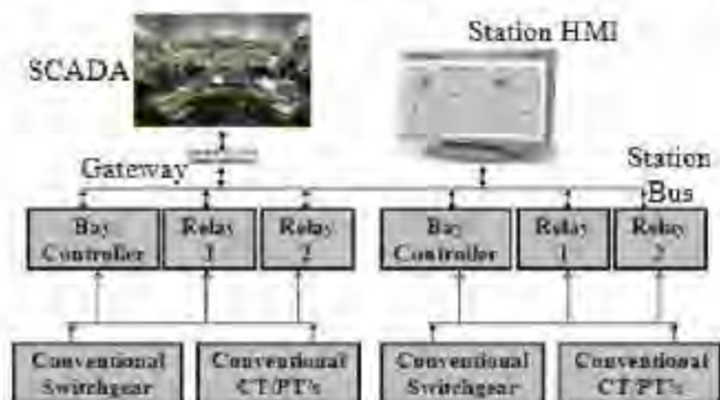
Fig. 5: IEC 61850 based SA system
