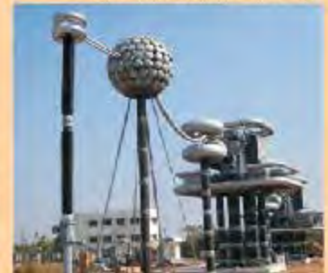
1200kV CVT under test
